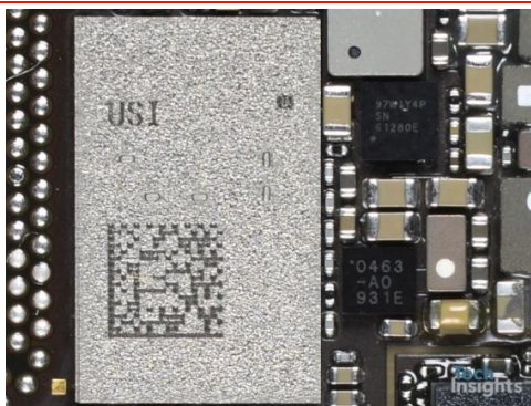
图表54： iPhone 11 系列上由环旭电子封测的 U1 芯片
