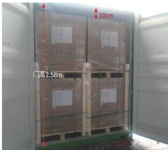
图表14: 两托堆码后仍有 10cm 操作空间
