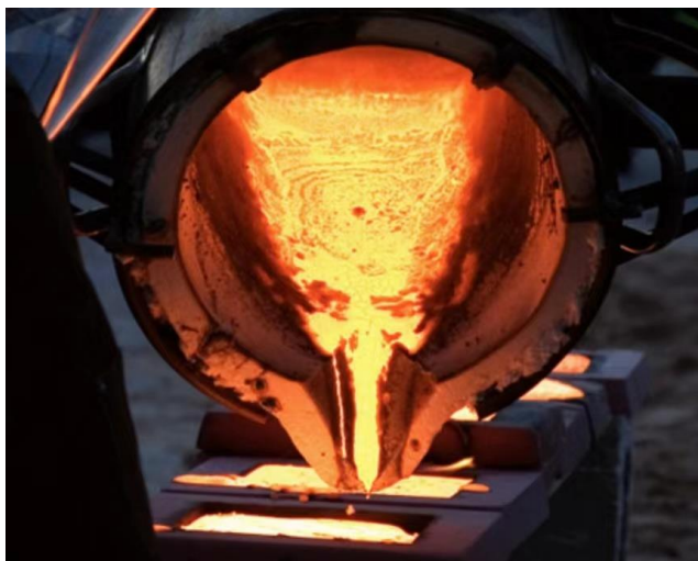
图表94： 铸造：将液体金属浇铸到与零件形状相适应的铸造空腔
