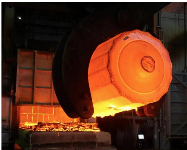
图表93： 锻造：施加压力产生塑性变形
